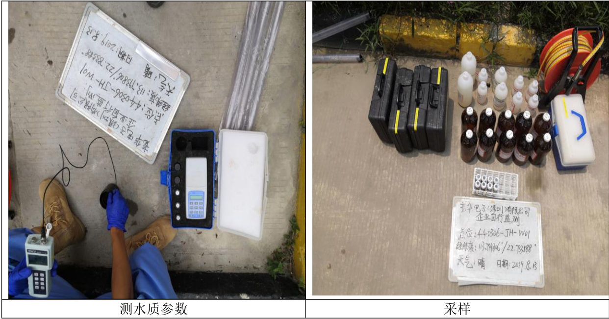
图7-2 地下水样品采集(W01)
